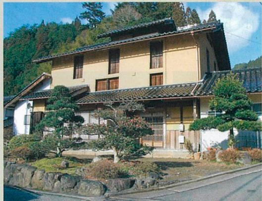
風情のある土壁に越屋根が印象的な「中3階建て養蚕住宅」。蚕の飼育面積を確保するため、3階部分が付け足された。リズム感のある窓の配置や、切り妻屋根とひさしのシンプルなラインは、ノスタルジックな佇まいを醸し出している。
